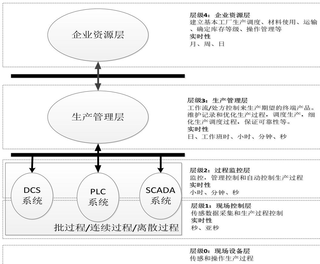
注：该图为工业控制系统经典层次模型参考自国际标准IEC 62264-1，但随着工业4.0、信息物理系统的发展，已不能完全适用，因此对于不同的行业企业实际发展情况，允许部分层级合并。
